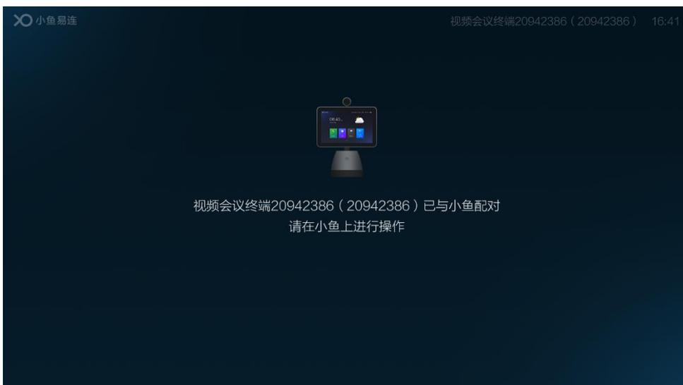
3. 通过会议终端或一体化终端呼叫会议号码，会议终端即成功加入会议。一体化终端成为该会议终端的全触屏控制台，用户可通过触屏操作实现对会议的管理，无需使用遥控器。一体化终端界面如图 7-3 所示。
