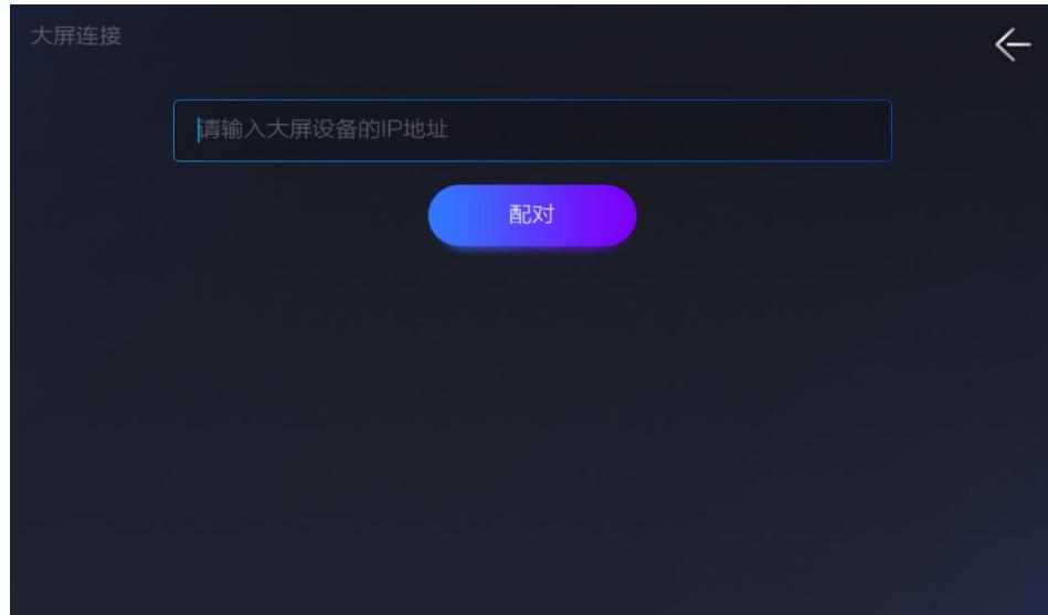
2. 输入会议终端的 IP 地址，点击配对按钮。配对成功后，会议终端界面如图 7-2 所示。
