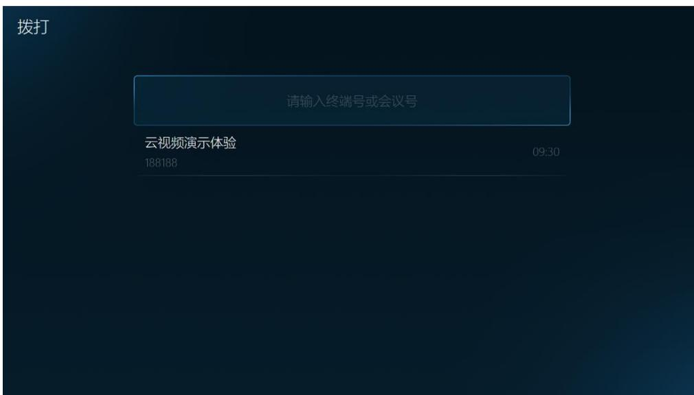
2. 按遥控器的数字键，在输入框中输入要呼叫的终端号或云会议号，按 **OK** 键，发起呼叫。
