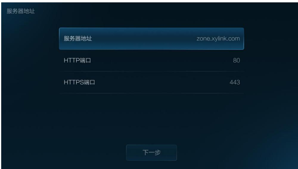
4. 设置服务器地址，点击下一步按钮，启动终端检测功能，包括网络连接、摄像头、扬声器以及麦克风，如图 2-4 所示。
