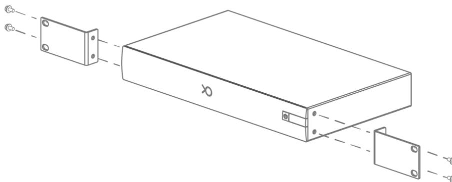
2. 将终端水平推入机柜，用螺钉将终端固定在机柜上，如图 1-2 所示。
