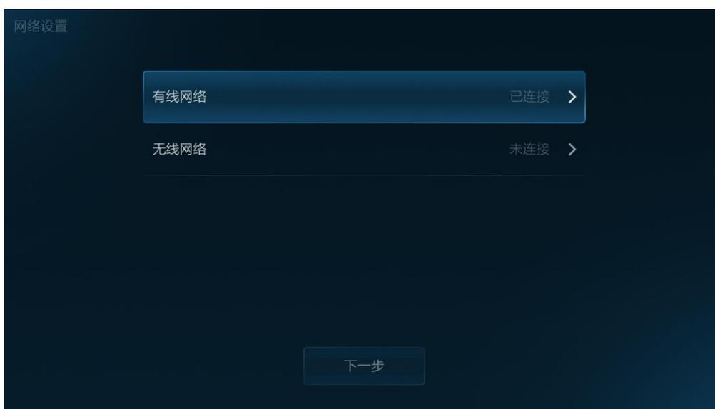
3. 选择有线或无线网络进行连接，点击下一步按钮，打开服务器地址设置界面，如图 2-3 所示。
