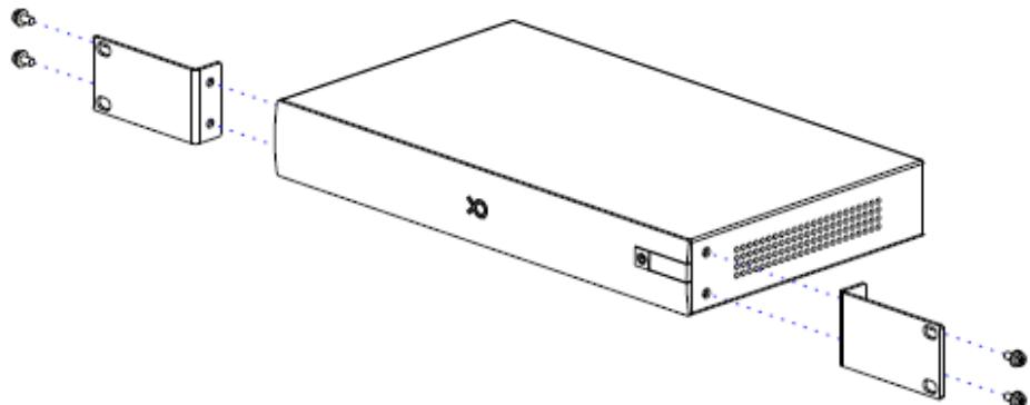
2. 将终端水平推入机柜，用螺钉将终端固定在机柜上，如图 1-2 所示。
