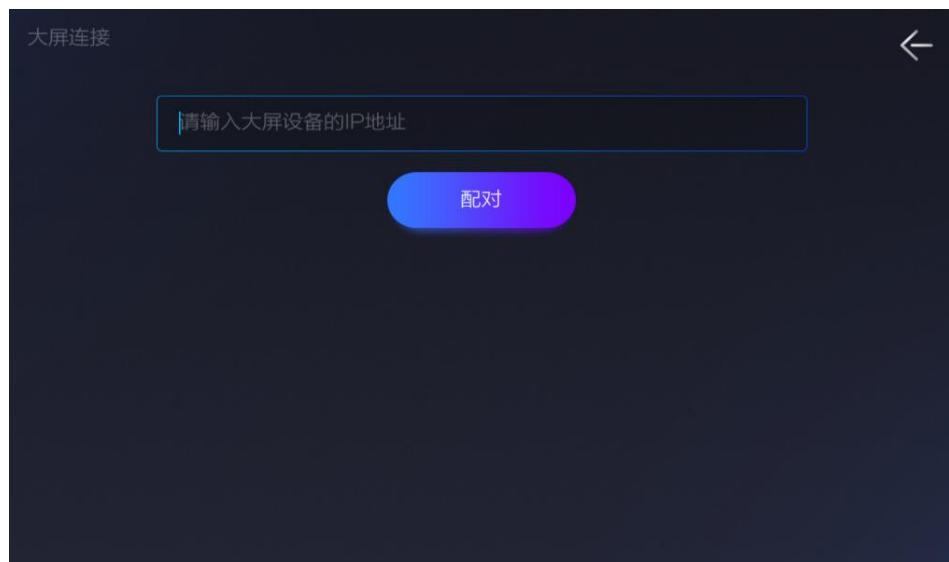
2. 输入会议终端的 IP 地址，点击配对按钮。配对成功后，会议终端的界面如图 7-2 所示。
