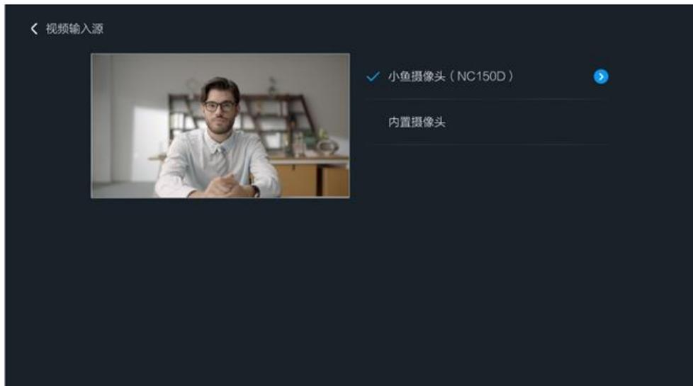
一体化终端支持通过 POE 接口外接 NC90 和 NC150D 摄像头，连接成功后系统将自动切换外接摄像头做视频输入源。用户也可根据实际情况在**视频输入**界面手动选择所需摄像头。若用户手动已经选择了内置摄像头，插拔摄像头将不会自动切换视频输入源。
