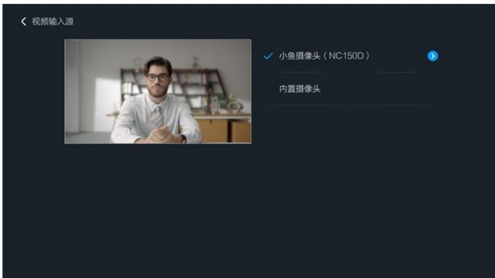
一体化智能终端支持通过 POE 接口外接 NC90 和 NC150D 摄像头，连接成功后系统将自动切换外接摄像头做视频输入源。用户也可根据实际情况在**视频输入**界面手动选择所需摄像头。若用户手动已经选择了内置摄像头，插拔摄像头将不会自动切换视频输入源。
