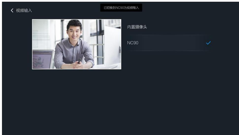
一体化终端支持通过 POE 接口外接 NC90 摄像头，连接成功后系统将自动切换为 NC90 做视频输入源。
