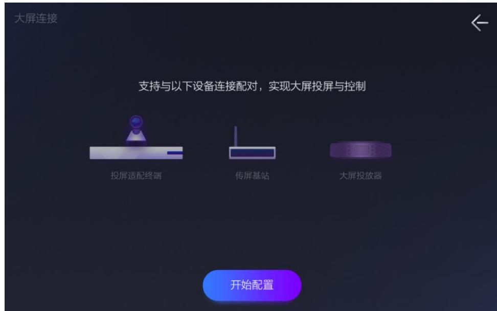
2. 点击**开始配置**按钮，打开配对界面，如图 6-2 所示。与一体化终端位在同一网段的未配对设备可被自动识别，显示在**未配对设备**列表中。
